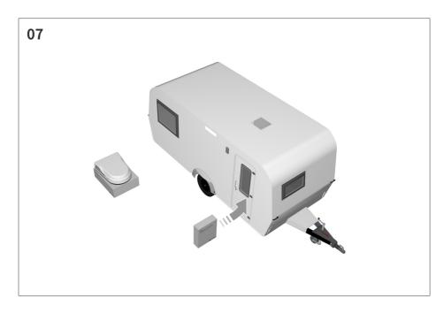
· 在安装内面板时如发现外主机位置有偏差,可在内部通过安装孔微调顶置空调主机。
