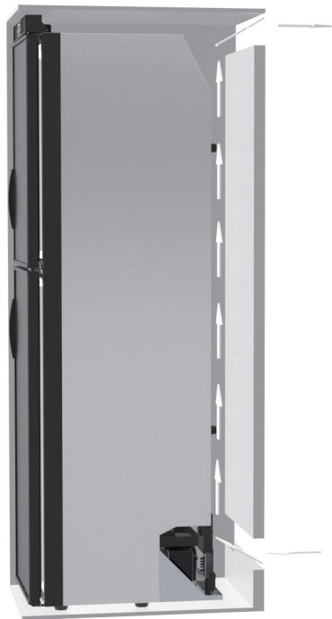
外散热循环安装方式
